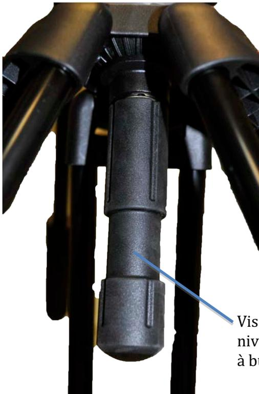
Vis permettant de faire le niveau (à utiliser avec le niveau à bulle)
